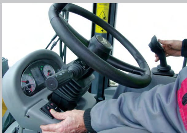
Elektrische proportionele afstelling van de hydraulische prestatie van het 3e en 4e circuit.
