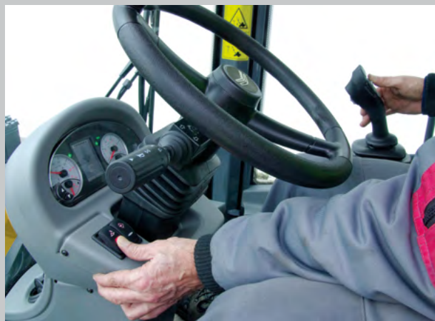
Elektrische proportionele aanpassing van de hydraulische prestatie van het 3e en 4e circuit.
