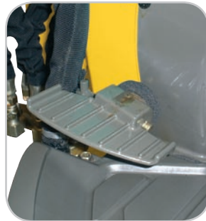
Inklapbare pedalen (pedaal bediening hulphydrauliek en pedaal giekverstelling)
